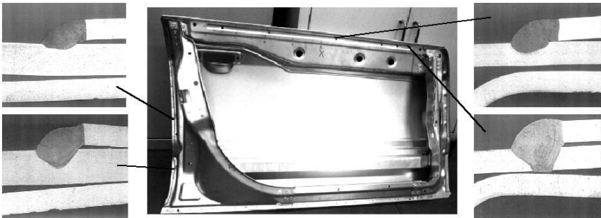
Bild 7-19: Aluminiumtür eines AUDI A8 als Demonstrator: Mit einem 3 kW Nd:YAG-Laser und pulverförmigem ZW geschweißte Kehlnaht am Überlappstoß (Bördelnaht) als Alternative zu einer Falzklebung [80].
