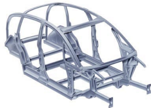
Bild 1-2: Rahmen des Konzeptfahrzeugs Al 2 , Space Frame, ASF®.
