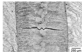
Bild 2-9: Aufschliff einer Schweißnaht mit querliegendem Heißriß [14].
