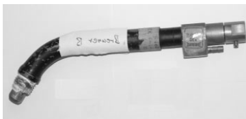
Bild 3.10: Schweißpistolenkopf Dinse SO 551 zur Zusatzdrahtzufuhr für das MIG-Schweißen (elektrisch isoliert).
