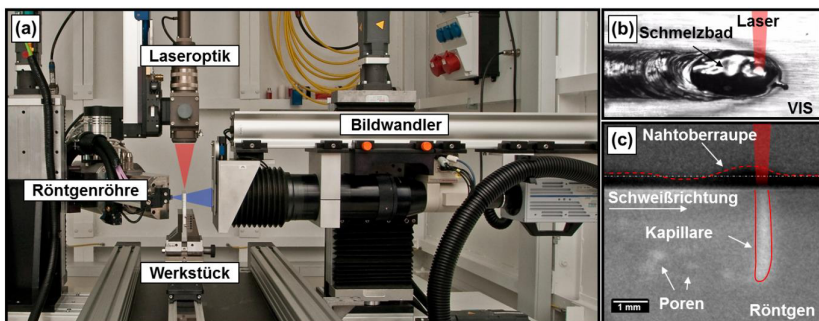
Abbildung 23: Hauptansicht des IFSW-Röntgensystems mit Röntgenröhre, Laseroptik, Werkstück und Bildwandler. Der Laserstrahl trifft von oben auf das Werkstück, während dieses seitlich von der Röntgenstrahlung durchstrahlt wird [79][80][81][82].
