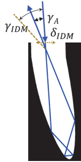
Bild 3.7: Beispiel der Ausbreitung eines Teilstrahls in einer Kapillare. Hier wird der Messstrahl unter einem kleinen Winkel zur Oberflächennormalen eingebracht. Verlässt der Strahl die Kapillare in einem Winkel \gamma_A der kleiner oder gleich dem Divergenzwinkel des Messstrahls \gamma_{IDM} ist und sich innerhalb des Strahldurchmessers \delta_{IDM} befindet, trägt dieser zum Ergebnis der Berechnung bei.
