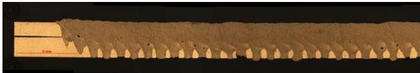
Bild 7.31: Längsschnitt einer stufenförmigen Laserleistungsmodulation mit 70 Hz. (Parameter: P =moduliert, v = 5 m/min, S_L = 80 mm, d_f = 400 \mu m, z_f = 0 mm, R = 3 mm, SG = Argon, d_{OB} = 1,2 mm, d_{UB} = 1,5 mm, MAT = AA 6016, seitliche Einspannung)
