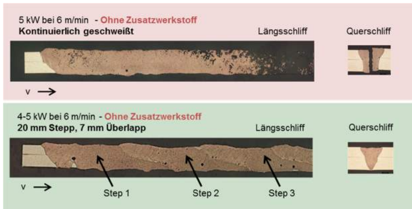
Bild 7.45: Oben: Kontinuierliches Schweißen der schmalen Versuchsprobe.
