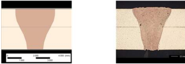
Bild 3.9: Links: Berechneter Schweißnahtquerschnitt während des Schweißprozesses. Rechts: Querschliff der erstarrten Schweißnaht zur Kalibrierung des Wärmeeintrages. (Parameter: P = 5 \text{ kW} , v = 6 \text{ m/min} , d_f = 650 \text{ }\mu\text{m} , R = 10 \text{ mm} , l_s = 60 \text{ mm} , z_f = 0 \text{ mm} , d_{OB} = 1,2 \text{ mm} , d_{UB} = 1,5 \text{ mm} , MAT = AA 6016, seitliche Einspannung)
