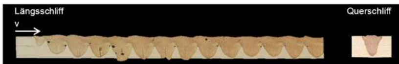
Bild 7.21: Längsschnitt einer Schweißnaht mit sinusförmig modulierter Laserleistung.
