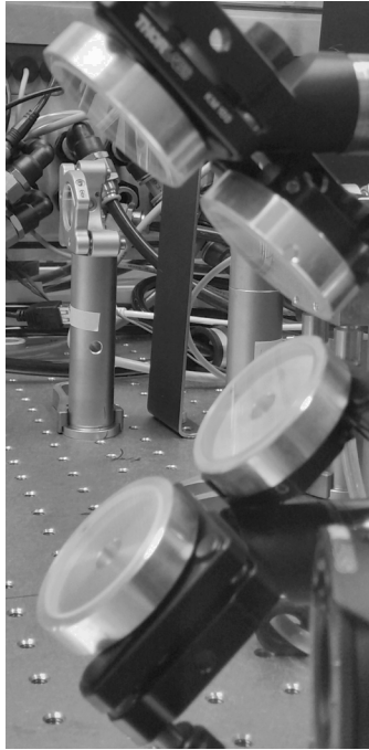
Bild 3.16: Foto des retroreflektierenden Spiegelpaars.
