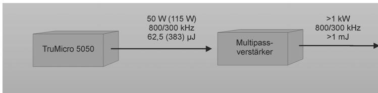
Bild 2.1: Grundkonzept des Systems, welches zu entwickeln war. Ein kommerzielles UKP-Lasersystem (TruMicro5050) wurde als Seedquelle verwendet. Es emittierte Laserpulse mit 6.5 ps Pulsdauer bei einer zwischen 300 kHz und 800 kHz umschaltbaren Repetitionsrate. Die nominelle Durchschnittsleistung betrug 50 W und wurde während der Experimente auf bis zu 115 W gesteigert. Ziel der Arbeit war es nun ein Scheibenlasermultipasssystem zu entwickeln um die Ausgangsleistung auf mehr als 1 kW zu steigern.
