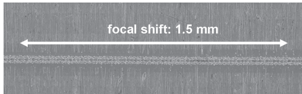
Bild 5.25: Ausschnitt einer Lasernut in Stahl bei Variation des Abstandes des Axikons zum Werkstück. Die Bearbeitungsparameter entsprechen denen aus Bild 5.24.
