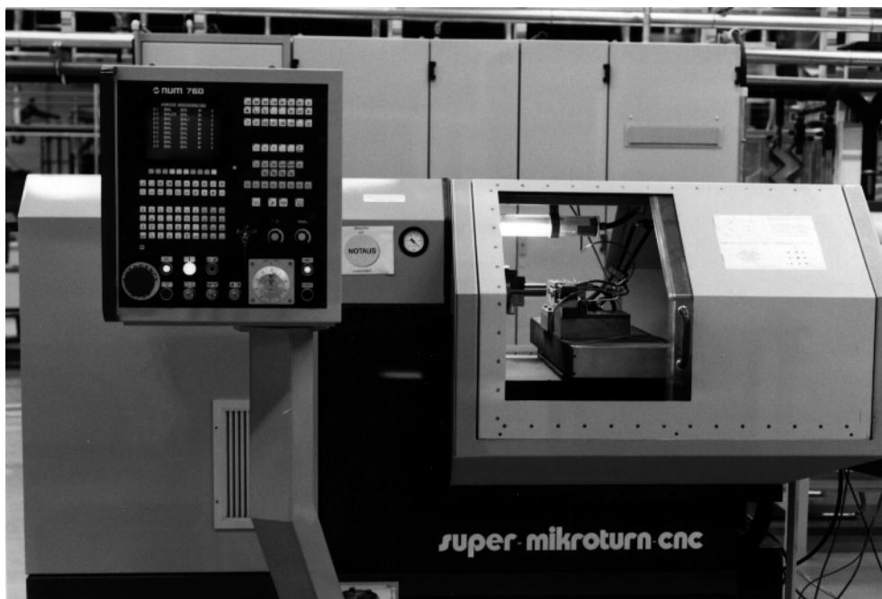
Bild 91: Präzisions-Drehmaschine „Super-Mikroturn CNC“ der Firma Hembrug.
