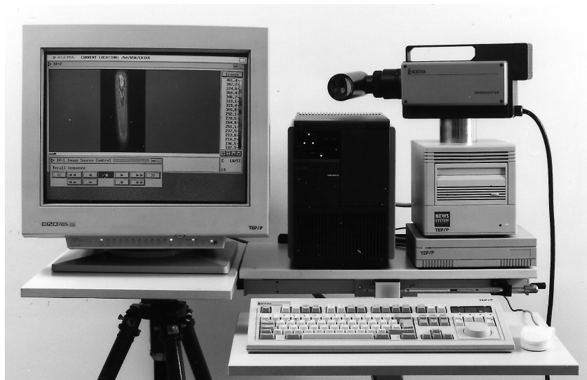
Bild 33: Hardware-Komponenten des IR-Thermografiesystems.
