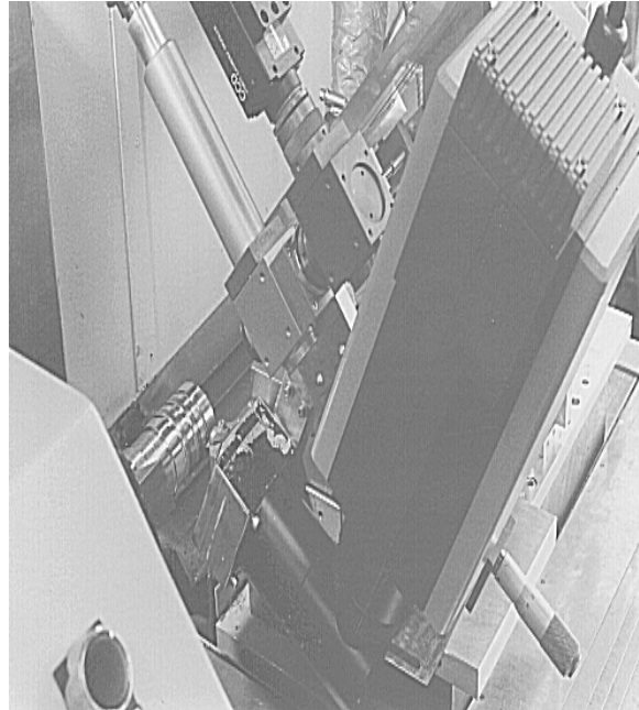
Bild 93: Versuchsaufbau zur laserunterstützten Zerspanung.
