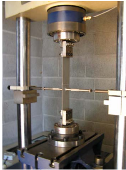
Bild 3.12: Für die Untersuchungen an der FHT Esslingen eingesetzte 70 kN- Resonanzprüfanlage Amsler Typ HFP 5500, Führung der Probe durch Gewindebolzen.
