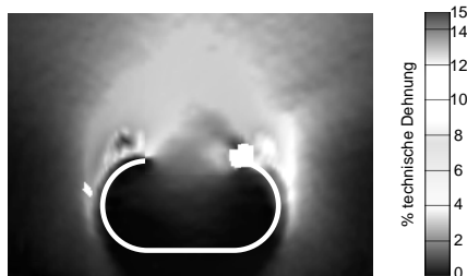
Bild 3.14: Darstellung der technischen Dehnungsverteilung im Bereich einer Klammer-Schweißnaht (Werkstoff H320LA, Blechdickenkombination 0,7/0,7 mm).
