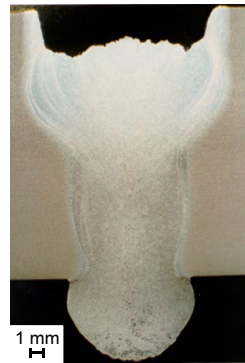
Abb. 7.6: Schweißnahtquerschnitt von AlMg4,5Mn, Dicke t=20 mm, v=0,25 m/min, P=3+3+4 kW.
