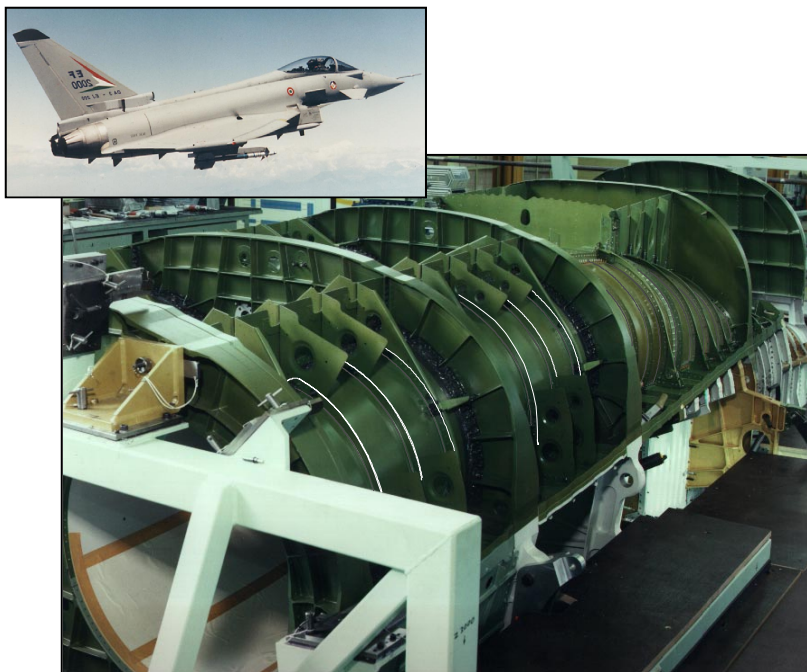
Abb. 8.5: Wing Attachment Box des Eurofighters mit markierten Schweißnähten an den Verstärkungselementen der Lufteinlaufschalen, Quelle: EADS, Werk Augsburg [110].
