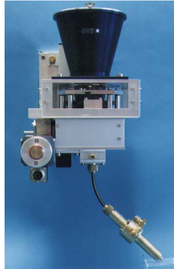
Bild 4.14: Schnittzeichnung des IFSW-Pulverförderers [12] und Außenansicht.
