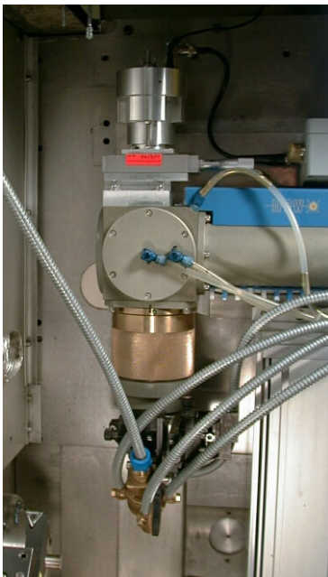
Bild 4.16: Detektion von Prozesssignalen aus der Wechselwirkungszone koaxial zum Bearbeitungslaserstrahl durch die Bearbeitungsoptik. Der Umlenkspiegel dient dabei als Strahlteiler.
