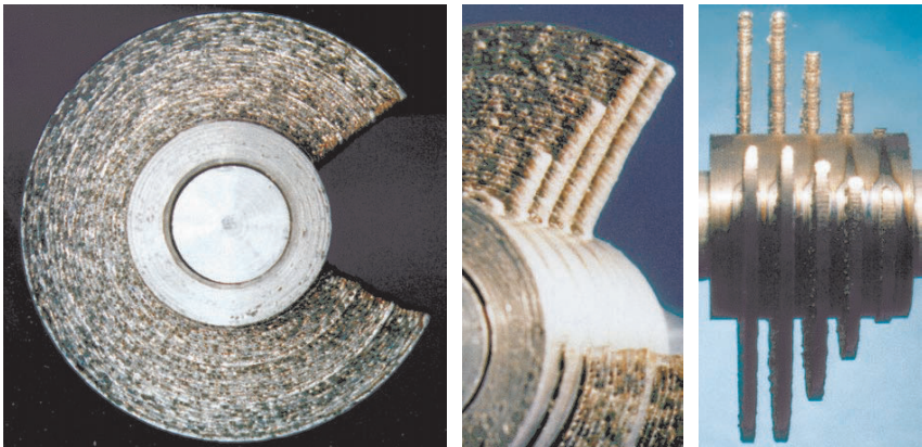
Bild 5.1: Demonstrationsteil für den Aufbau von Spurstapeln: Auf Rohrmaterial (Durchmesser 14 mm) im Abstand von 2,5 mm aufgebaute Spurstapel aus 1, 10, 20 und 30 Spuren mit jeweils 0,3 mm Höhe und 1 mm Breite.
