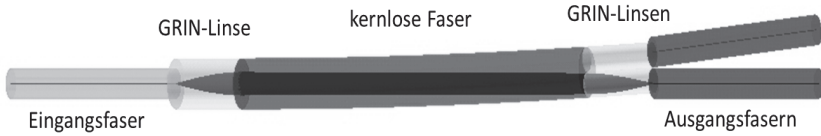
Bild 2.7: Simulationsergebnis einer optischen Strahlweiche in streng monolithischer Ausführungsform auf Basis von drei GRIN-Linsen nach [33].
