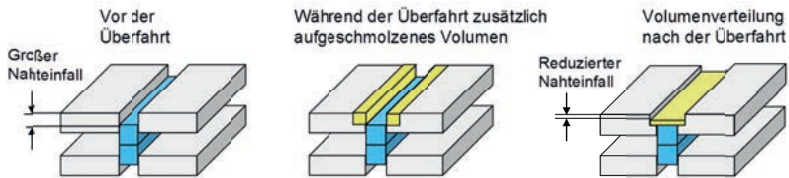
Abbildung 6.4: Prinzipskizze zur Reduzierung scharfer Einbrandkerben und großem Nahteinfall: Kantenabschmelzen durch eine zweite Überfahrt mit defokussiertem Laserstrahl.
