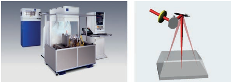
Abbildung 2.15: Remote-Welding mit CO 2 Laser: Portalanlage (links), Strahlführungsprinzip und Arbeitsvolumen (rechts) [Quelle: Trumpf].
