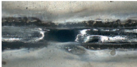
Abbildung 5.23: Fotografische Aufnahme eines Schmelzbadabrissloches im Bereich der Schweißnahtmitte mit glänzender, glatter Obertraupe und scharfkantigen Rändern (Spaltmaß: s = 0,3 \text{ mm} ).
