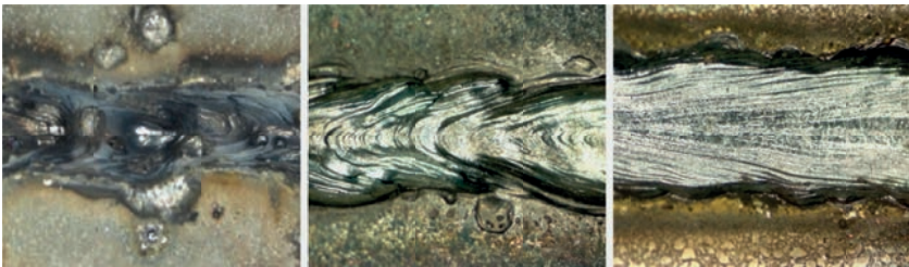
Abbildung 5.6: Spaltabhängige Topografie der Nahtberraupe bei Überlappschweißnähten auf verzinkten Blechen (links: Nullspalt, Mitte: 0,05 mm Spalt, rechts: 0,25 mm Spalt). P_L=4,0 kW, v=5 m/min.
