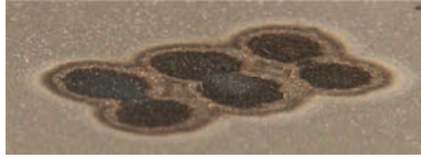
Abbildung 4.6: Keine Noppenentstehung bei zu geringer Intensität in Folge zu hoher Defokussierung (6er Noppenmatrix, Pulszeit: 20 ms, Defokussierung 36 mm).
