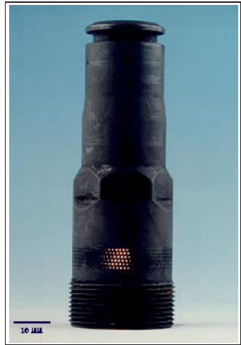
Bild 2.1: An der Düsenspannschraube werden in 5 s 540 Löcher mit Einzelpulsbohren eingebracht (aus [1]).
