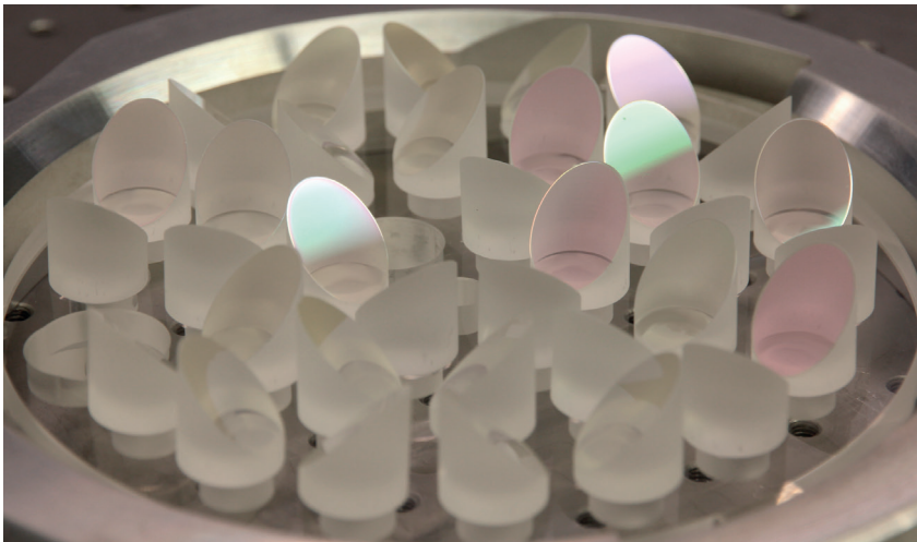
Bild 5.9: Spiegelarray aus Quarzglas für Multipass-Scheibenlaser-Verstärker.
