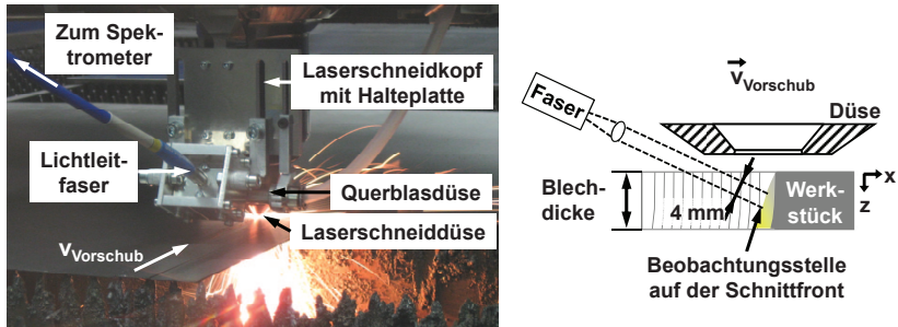
Bild 4.1: Versuchsaufbau der off-axis Spektromettermessung.
