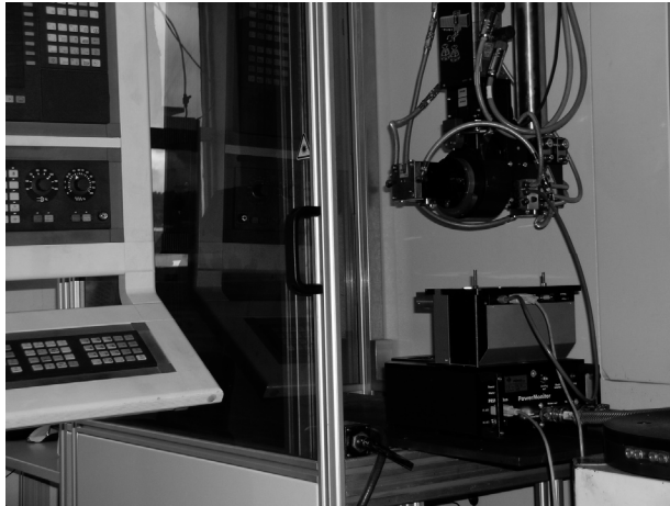
Bild 3.9: Versuchsaufbau für die Schweißuntersuchungen mit dem CO 2 -Laser [Quelle: Daimler AG].
