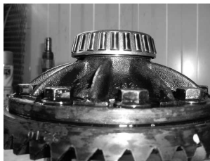
Bild 4.26: Verschraubung des Ausgleichsgetriebegehäuses mit dem Tellerrad [59].
