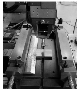
Bild 3.8: Versuchsaufbau für die Schweißuntersuchungen mit dem Faserlaser [Quelle: SLV-Rostock].
