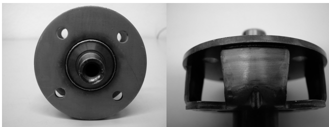
Bild 1.1: Abtriebswelle des neuen automatischen Getriebes (NAG): axiale Schweißung (links) und radiale Schweißung (rechts) [Quelle: Daimler AG].
