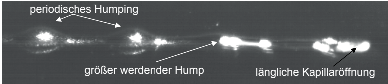
Bild 5.4: Aufnahme einer Hochgeschwindigkeitskamera bei einer Schweißgeschwindigkeit von v = 60 m/min und einer Leistung von P = 600 W.
