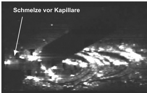
Bild 108: Schmelze tritt vor Kapillare aus Schmelzbad
