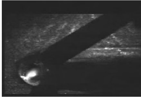
Bild 113: Ruhiges Schmelzbad durch „Entlasten“ der Kapillare bei AA6181A
