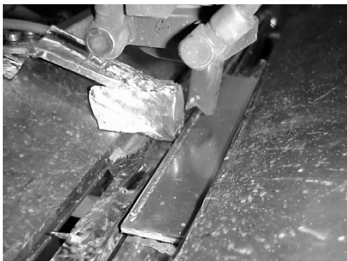
Bild 76: Versuchsaufbau: Nd:YAG; AA 6181A; s_M = 4 \text{ mm} ; P_L = 4 \text{ kW} ; v_s = 4 \text{ m/min} ; He 4.6 40 l/min
