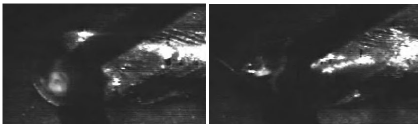
Bild 131: Auslenken der Schmelze zur Seite mit vergrößertem Schmelzbad bei 200 Hz (AA6181A).
