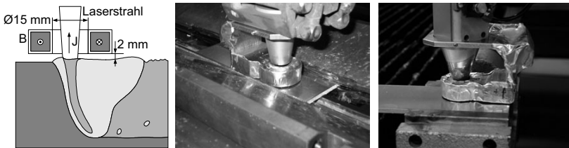
Bild 72: Aufbau zum Nachweis einer emittierten Ladung, Mitte Nd:YAG-, rechts CO 2 -Laser
