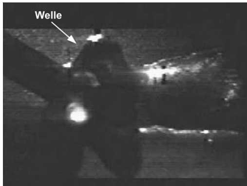
Bild 96: Schmelze wird neben Kapillare angehoben (AA 6181A)
