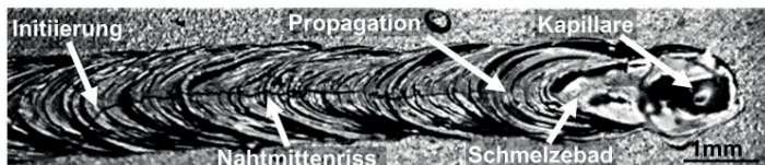
Bild 1.4: Einzelbild aus einem High-Speed Video der Bildung (Initiierung) und Fortpflanzung (Propagation) eines Nahtmittensplisses beim Schweißen eines 0,9 mm dicken AA6541 Bleches.
