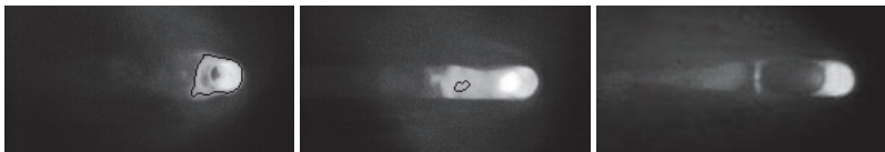
Bild 4.24: Links: Fehlerkennung des gesamten Kapillarbereichs als Durchschweißloch. Mitte: Fehlerkennung im Schmelzebad [68]. Rechts: Kein FPH erkannt, da keine geschlossene Kontur gefunden werden konnte.
