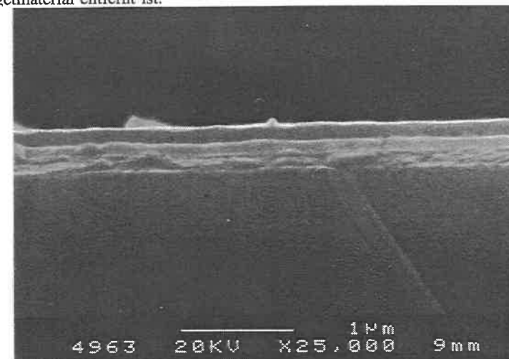
Bild 59: Querbruch durch eine Kombinationsbeschichtung aus Magnesium und Titan auf einem Glassubstrat.
