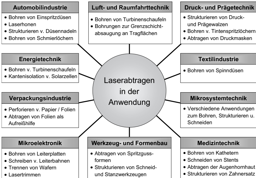
Bild 2-2: Anwendungsfelder in denen bereits heute abtragende Laserverfahren industriell eingesetzt [4 – 25, bzw. als adäquates Mittel für die Serienproduktion qualifiziert wurden [26, 27].
