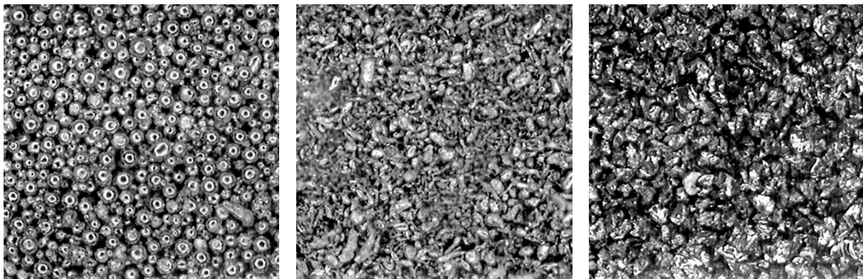
Bild 7.6: Unterschiedliche Kornformen der Pulver. Links: sphärisch (TLS AlSi12), Mitte: spratzig (Ecka AlSi12), rechts: blockig (Plasmatex CrB2)
