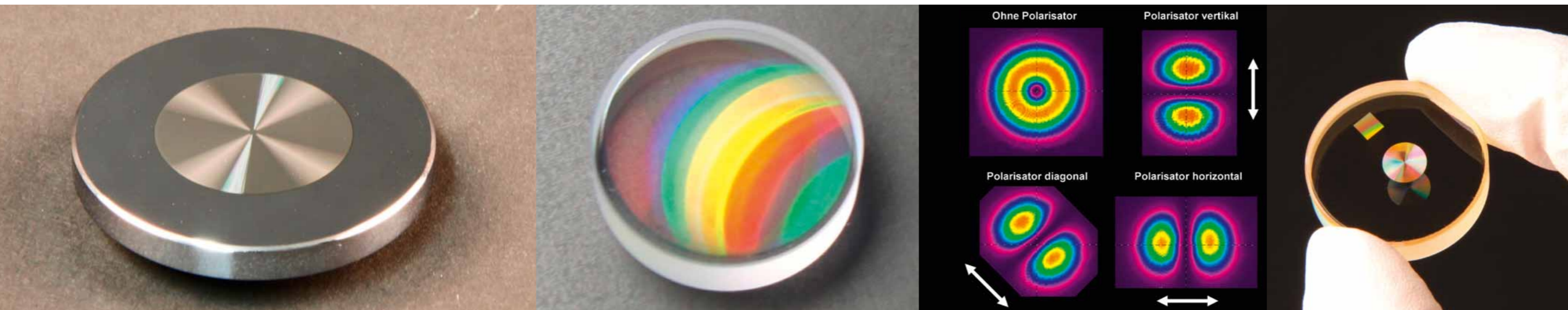
Links: Radial polarisierender Gitterspiegel für CO 2 Laser
