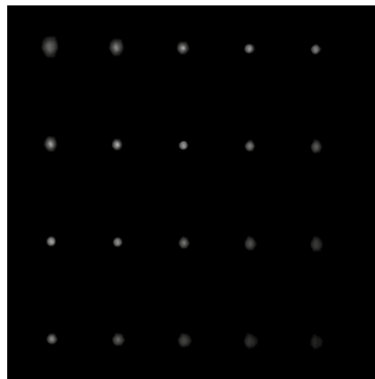
Links: Mechanischer Aufbau zur Echtzeitmessung der Strahlkaustik Rechts: Strahlprofil in verschiedenen Ebenen der Kaustik
