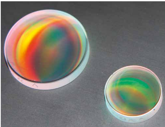
Pulskompressionsgitter mit 38.1 mm und 25 mm Substratdurchmesser
