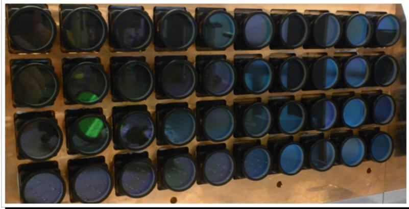
Abb. 1: Foto der Spiegelmatrix zur Faltung des Strahlengangs im Multipassverstärker. Es werden 40 Spiegel eingesetzt, welche einzeln justierbar auf einer gekühlten Kupferplatte angebracht sind.
