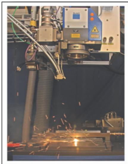
Bild 4: Scanneroptik während eines Remote-Schweißprozesses.
