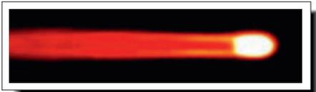
Abb. 1.: Wärmebild eines Schmelzbades (CMOS-Kamera)
