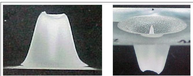
Abb. 4: Plexiglas-Einbrand des ringförmigen  $\text{CO}_2$ -Laserstrahls.
