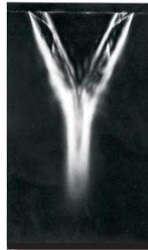
Abb. 2: 1,5-Mpa-Zweistrahldüse, Gasverbrauch: 220 Nl/min.
