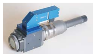
Abb. 4: FGSW-Detektorkopf FD12 an der Bearbeitungsoptik BEO D70 der Firma TRUMPF Laser.
