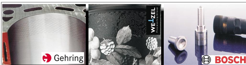
Abb. 1: Anwendungsbeispiele der Mikromaterialbearbeitung mit kurz gepulster Laserstrahlung bei Industriepartnern des IFSW: Laserhohnen von Zylinderlaufbahnen (Gehring), Strukturieren von Druck- und Prägewalzen (Wetzel) und Bohren von Kraftstoffeinspritzkomponenten (Bosch).
