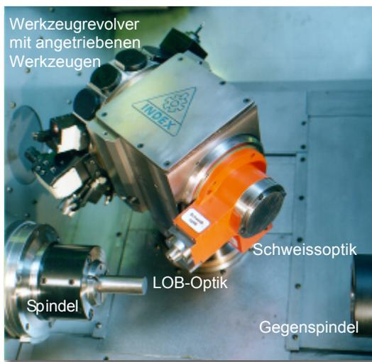
Abb.4: Arbeitsraum des Drehzentrums INDEX G200
