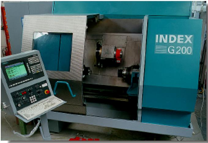
Abb.3: 5-Achs Drehzentrum mit vollständig integrierter Strahlführung
