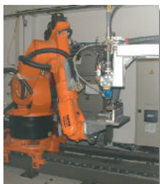
Abb.3: Roboter auf Linearachse mit 4,5 m Verfahrgeweg
