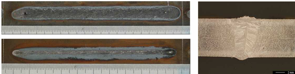
Abbildung 38: Nahtoberraupe (oben) und -unterraupe einer Blindschweißung einer 8-mm-Platte (Edelstahl 1.4404), rechts zugehöriger Querschliff; Laserleistung: 5 kW (10,6 \mu\text{m} ), Fokusslage: 0, Vorschub: 0,3 m/min, induktives Magnetsystem: 2817 Hz, 1025 W.
