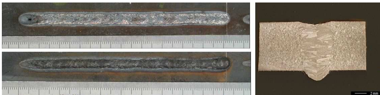
Abbildung 39: Nahtoberraupe (oben) und -unterraupe einer Blindschweißung einer 8-mm-Platte (Edelstahl 1.4404), rechts zugehöriger Querschliff; Laserleistung: 5 kW (10,6 \mu\text{m} ), Fokusslage: 0, Vorschub: 0,3 m/min, kein Magnetfeld (Referenz)
