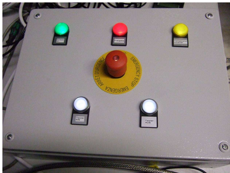
Abbildung 35: Aufbau einer leicht zu bedienenden Steuerbox
