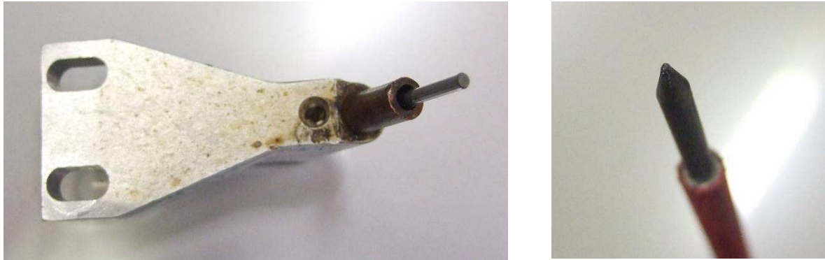
Abbildung 22: Schleifkontakt; links: Halterung mit Druckfeder (nicht sichtbar) und Wolframstift; rechts: Wolframstift mit spitzer Form
