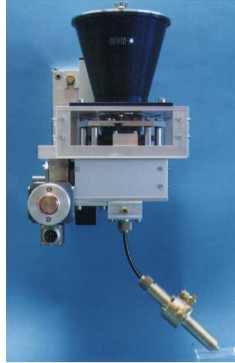
**Bild 4.14:** Schnittzeichnung des IFSW-Pulverförderers [12] und Außenansicht.
