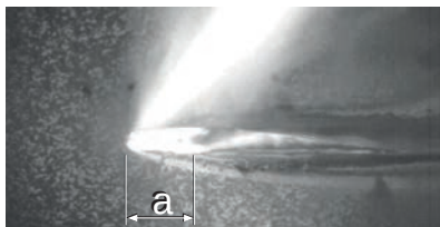
Steplänge = 10 mm; Spalt = 0,2 mm
