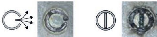
Abbildung 5.21: Links: Offenes Nahtmuster ermöglicht Zinkentgasung über den verbleibenden Spalt, Rechts: geschlossenes Nahtmuster behindert Zinkentgasung am Nahtende, Spritzer und Materialauswürfe trotz Spaltmaß von 0,1 mm sind die Folgen des durch das Schmelzbad entweichenden Dampfes.
