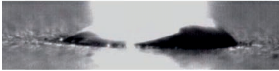
Abbildung 4.10: Hochgeschwindigkeits-Aufnahme einer Noppe bei z=12 mm, Zeitpunkt t=8 ms. Beginn der Entstehung einer Dampfkapillare und Schmelztransport in Richtung Rand.
