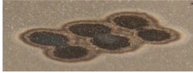
Abbildung 4.6: Keine Noppenentstehung bei zu geringer Intensität in Folge zu hoher Defokussierung (6er Noppenmatrix, Pulszeit: 20 ms, Defokussierung 36 mm).
