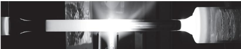
**Bild A.1.1:** MCVD-Drehbank im Betrieb am Institut für Strahlwerkzeuge (IFSW) [89].
