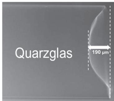
**Bild A.5.1:** Mikroskopaufnahme einer Quarzglas-basierter Faser, die an Na<sup>+</sup>/Li<sup>+</sup>-basierte Faser gespleißt wurde und danach abgebrochen ist. Die beiden geschichteten Linien markieren einen 190 µm tiefen Materialausbruch.
