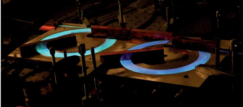
Abbildung 6.30: Fotografie des Scheibenlaser-gepumpten Faserlasers, aufgebaut mit hochreflektierendem *Fiber Bragg Grating* und aufgewickelt auf zwei wassergekühlte Aluminiumspiralen. Der Übergang von einer zur nächsten Spirale wurde mit einem Graphit-Silikon-Wärmespreizer realisiert.
