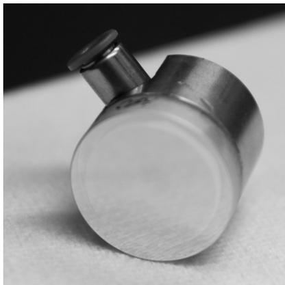
**Bild 4.7:** Sphärischer Druckspiegel auf Messinghalter
