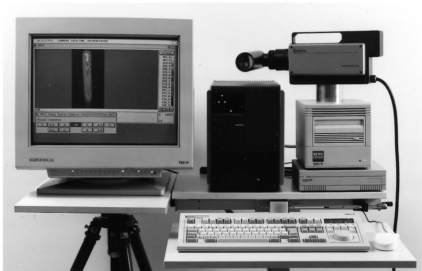
Bild 33: Hardware-Komponenten des IR-Thermografiesystems.
