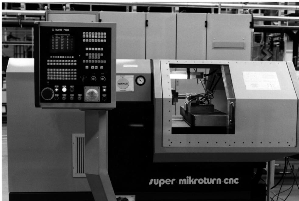
Bild 91: Präzisions-Drehmaschine „Super-Mikroturn CNC“ der Firma Hembrug.
