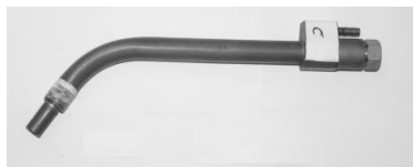
Bild 3.9: Schweißpistolenkopf Dinse SO 2013 zur Zusatzdrahtzufuhr für das Laserstrahlschweißen.
