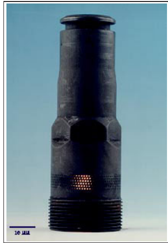
Bild 2.1: An der Düsenpannschraube werden in 5 s 540 Löcher mit Einzelpulsbohren eingebracht (aus [1]).
