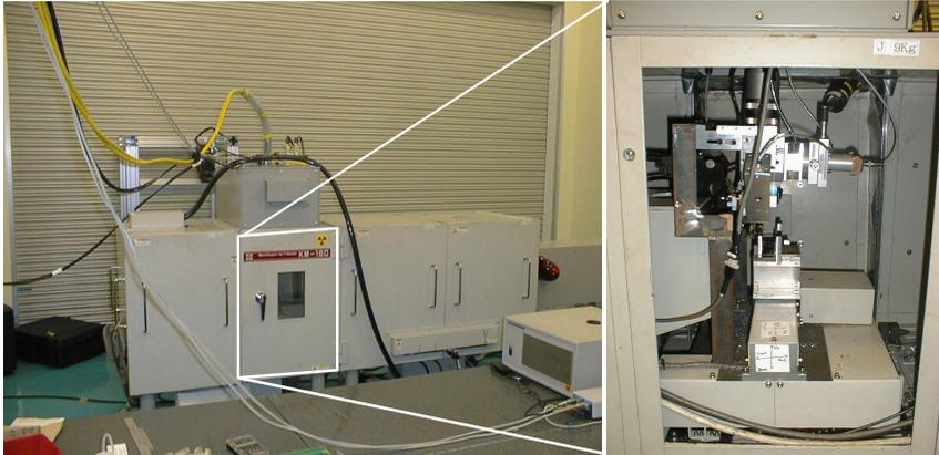
Abb. 3.9: Röntgenanlage (links), Ausschnitt mit geöffneter Tür zeigt Optikhalter, Fokussierung, Prozesssensorik und Vorschubeinheit (rechts)
