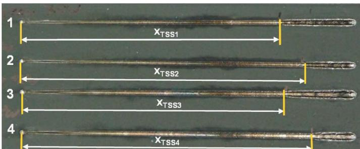
**Bild 3.35:** Ergebnis des Referenzprozesses mit eindeutig erkennbarer Tiefschweißschwelle.
