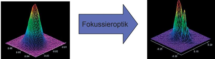
**Bild 3.9:** Intensitätsverteilung eines Singlemode-Faserlasers in der Fokusebene links nach der Faser  $M^2 = 1,2$  und rechts nach einer nicht geeigneten Fokussieroptik  $M^2 = 3,4$ .
