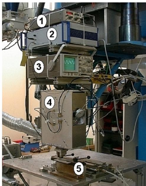
**Bild 3.10:** Bearbeitungsstation mit Versuchsaufbau für Doppelfokustechnik.
