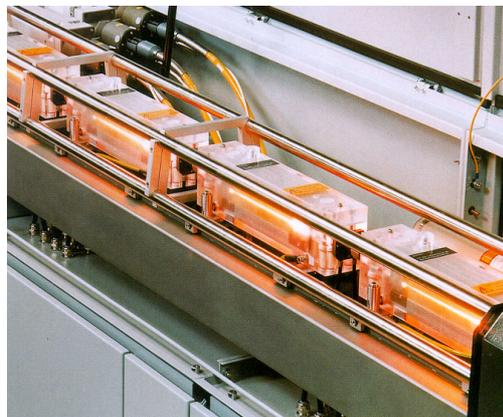
**Bild 3.1:** In Reihe geschaltete Kavitäten eines lampengepumpten Nd:YAG- Lasers [Quelle: TRUMPF- Laser].
