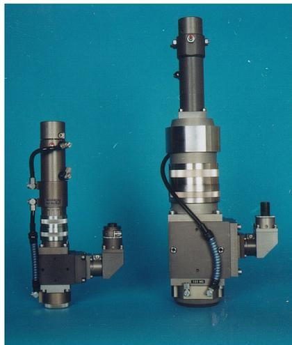
**Bild 3.5:** Standard- Bearbeitungsoptiken D35 (li) und D70 (re) [Quelle: TRUMPF- Laser].
