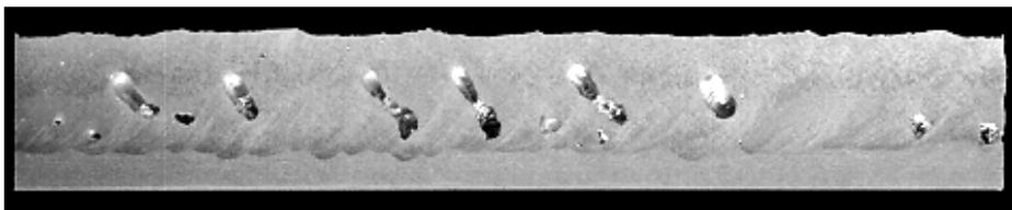
**Bild 2.11:** Längsschliff einer Laserschweißnaht mit Prozessporen ( $P_L = 4,0 \text{ kW}$ , AA 5xxx).
