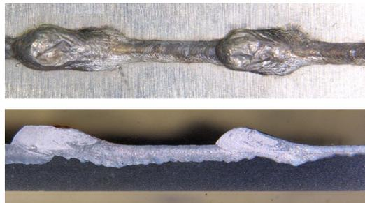
**Bild 5.27:** Beispiel einer Nahtberraupe mit dazugehörigem Längsschliff der Schweißnaht mit unregelmäßiger Tropfenbildung des Zusatzmaterials (Schweißrichtung von links nach rechts).
