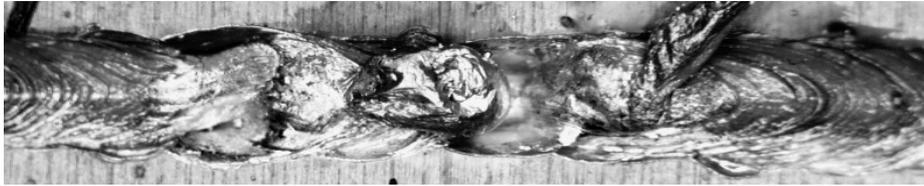
**Bild 2.13:** Foto einer Nahtoberraupe mit Schmelzbadauswurf ( $P_L = 4,0$  kW, AA 6xxx).
