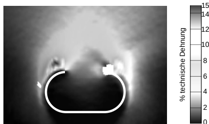
Bild 3.14: Darstellung der technischen Dehnungsverteilung im Bereich einer Klammer-Schweißnaht (Werkstoff H320LA, Blechdickenkombination 0,7/0,7 mm).
