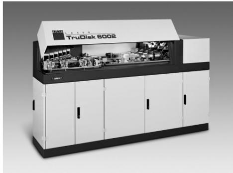
**Bild 3.2:** 6kW-Scheibenlaser [Quelle: Trumpf].
