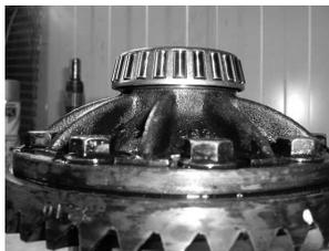
**Bild 4.26:** Verschraubung des Ausgleichsgetriebegehäuses mit dem Tellerrad [59].
