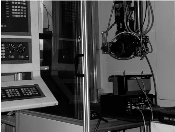
**Bild 3.9:** Versuchsaufbau für die Schweißuntersuchungen mit dem CO<sub>2</sub>-Laser [Quelle: Daimler AG].
